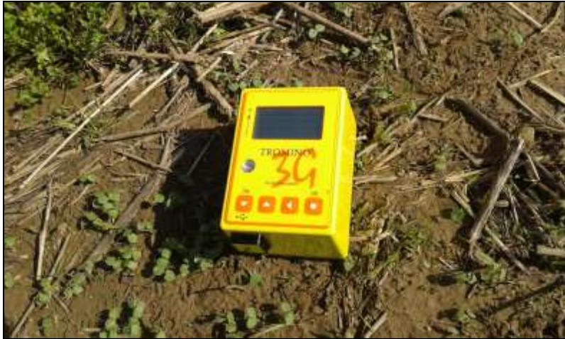
**Fig. 5:** esecuzione della misura di sismica passiva a stazione singola n. 1 nel sito di Capergnanica
