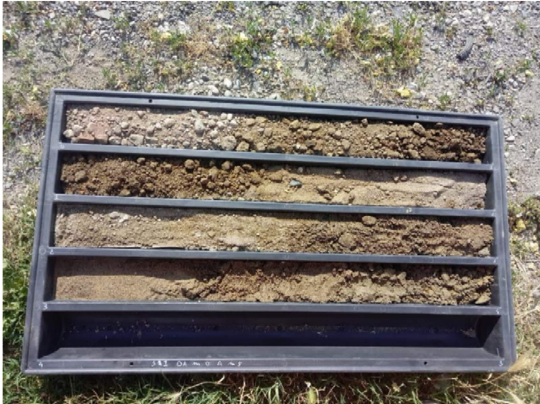
SONDAGGIO S1 – Cassa n.1 da 0.00 m a 4.00 m
