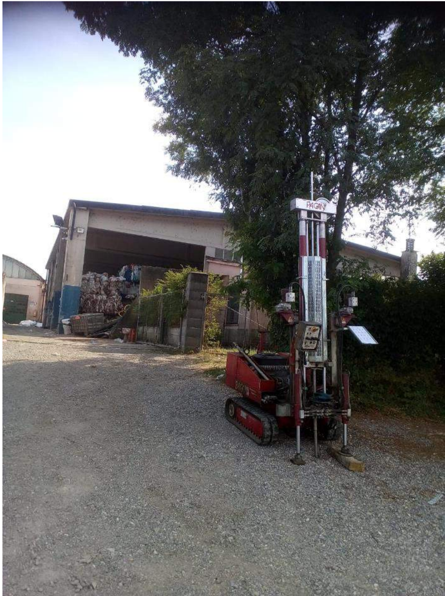
PROVA PENETROMETRICA DINAMICA SCPT-02 – Postazione
