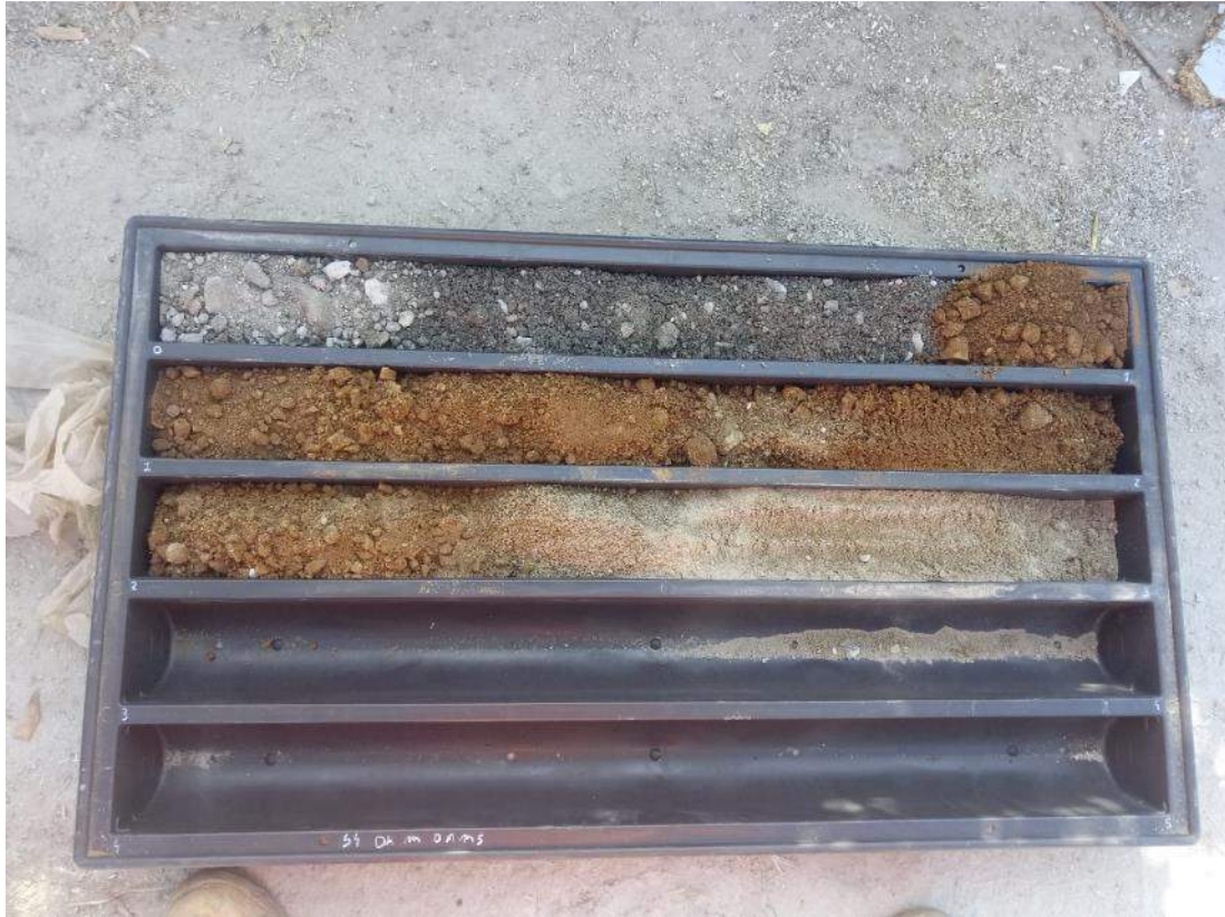
SONDAGGIO S4 – Cassa n.1 da 0.00 m a 5.00 m
