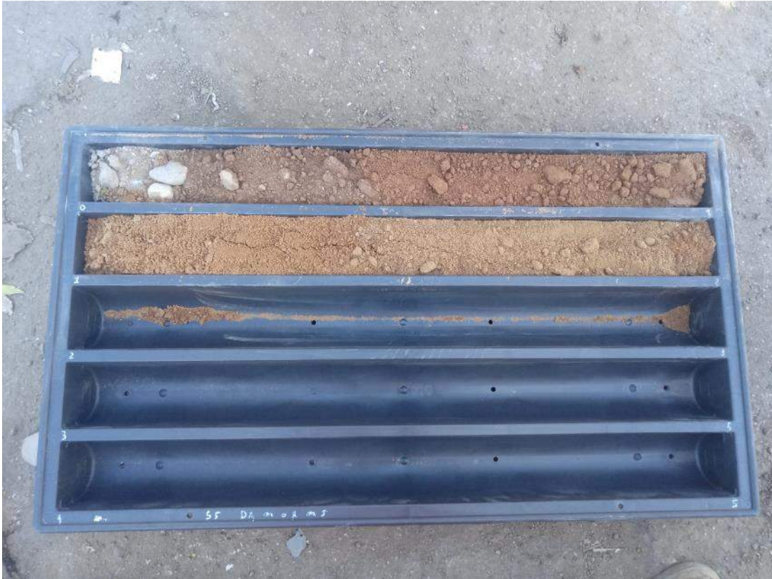
SONDAGGIO S5 – Cassa n.1 da 0.00 m a 5.00 m
