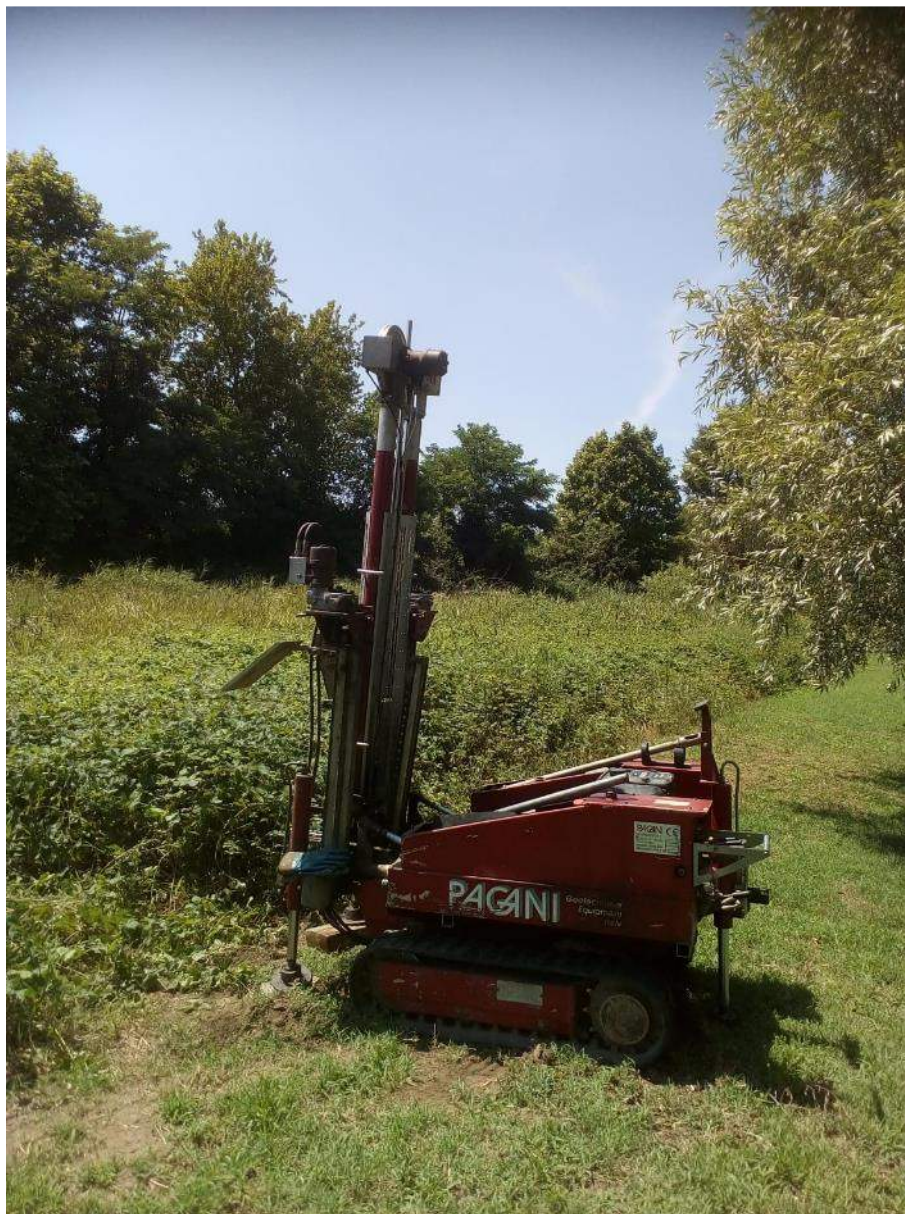
PROVA PENETROMETRICA DINAMICA SCPT-07 – Postazione
