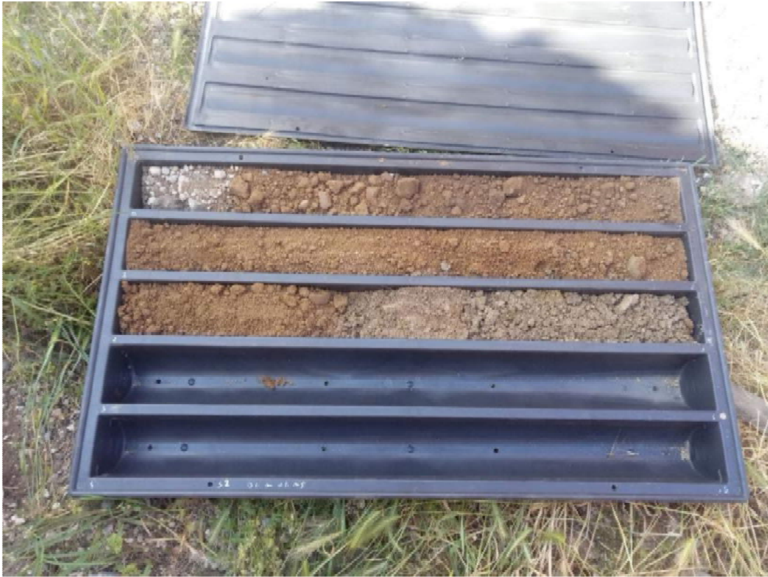
SONDAGGIO S2 – Cassa n.1 da 0.00 m a 3.00 m
